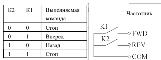
Рис.6-13 Двухпроводной режим управления 1
